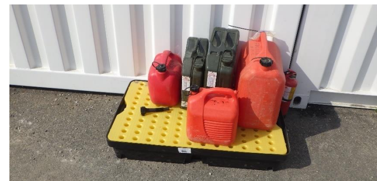
Figure 11 : Exemple de stockage sur bac étanche – Source : © IDE Environnement
